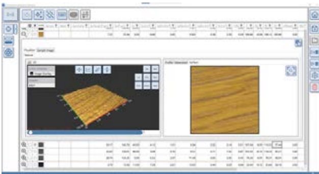
纹理模块显示在3D表面图上渲染的颜色正确的表面图像。
